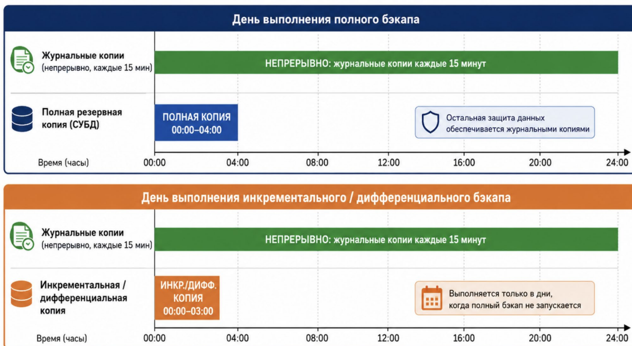
Рис. 3. Типовое расписание резервного копирования SAP-системы с разделением дня полного бэкапа и дня инкрементального/дифференциального бэкапа (составлено автором на основе [13, 22])
